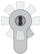
Fácilmente ajustable, la leva permite ocho posiciones alternativas para las diferentes funciones de las cerraduras.
